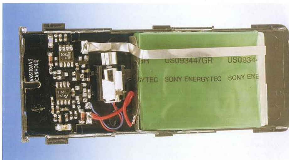
Figura 2. ¿Qué hay dentro de una batería de vibración comercial? El motor de vibración está montado entre el circuito de SMD que contiene el circuito de control de carga y la batería, que es de 3,6 V I-Ah (ión de litio).
