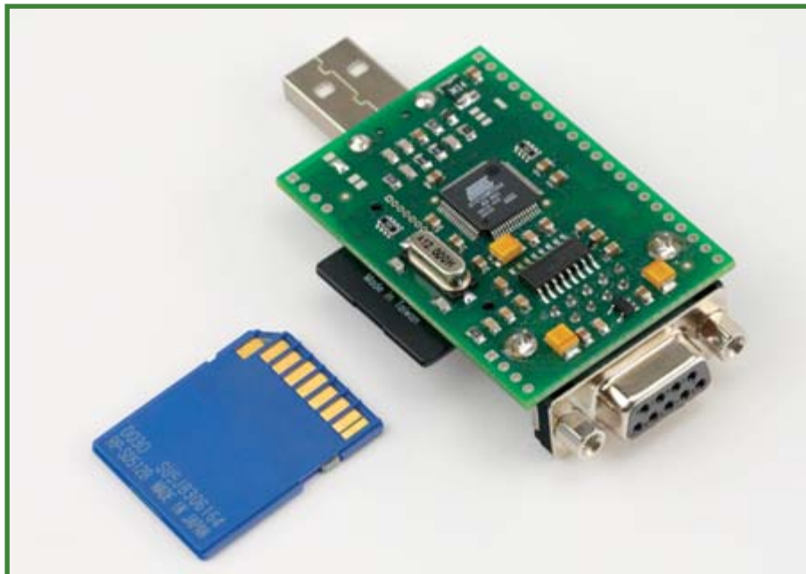
Figura 4. El microcontrolador AT 91SAM7S64, el circuito integrado MAX 232 y el cristal de 12 MHz, son los componentes más grandes en la cara inferior de la placa de circuito impreso.
