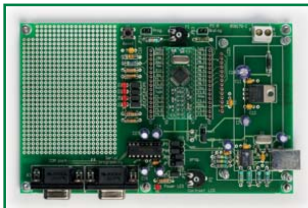
Figura 2. La placa de aplicación R8C de Elektor, publicada en el número de mayo de 2006, es una plataforma ideal de desarrollo.
