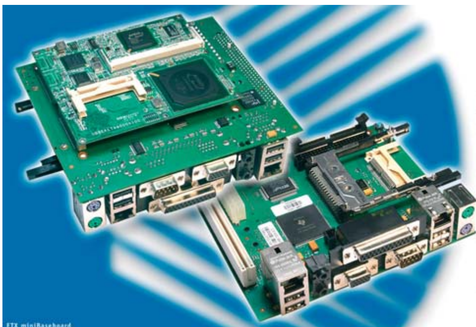
ETX® miniBaseboard ofrece todo lo necesario en 130 x 155 mm.
