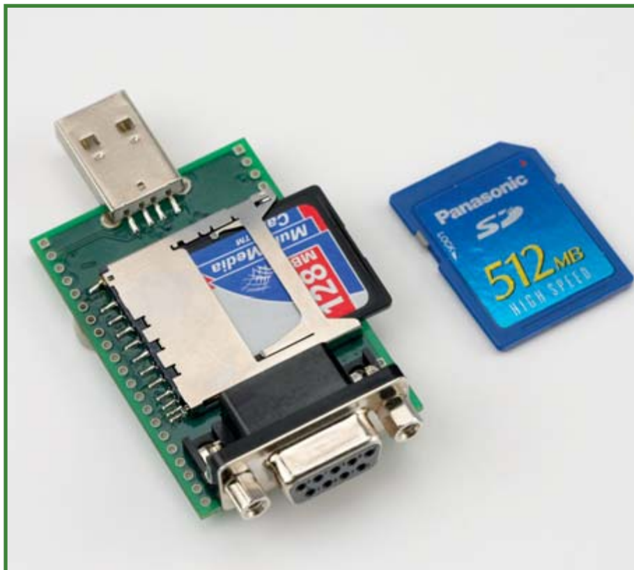
Figura 3. El conector USB, el conector RS 232 y el receptor para la tarjeta MMC / SD son los únicos componentes montados sobre una de las caras de la placa.
