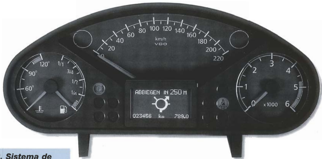
Figura 3. Sistema de navegación empotrado en el salpicadero de un vehículo. El sistema va conectado directamente al ordenador central.
