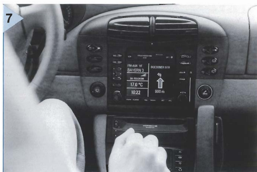
Figura 7. La información integrada en un sistema de posicionamiento de Siemens incluye el control del sistema de audio del vehículo, teléfono móvil y ordenador incorporado. Este sistema se ofrece como un extra en los automóviles Porsche.
