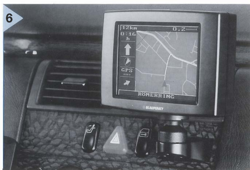
Figura 6. Es posible mostrar la ruta completa mediante un mapa electrónico en un monitor LCD.
