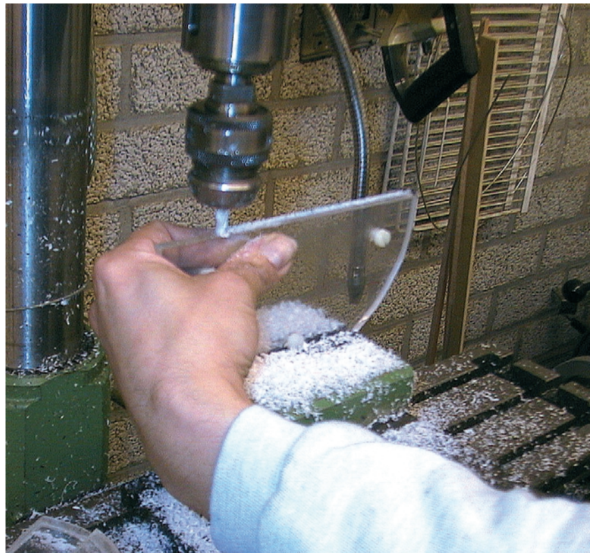
Figura 7. Perforando los agujeros en los semicírculos de Perspex.
