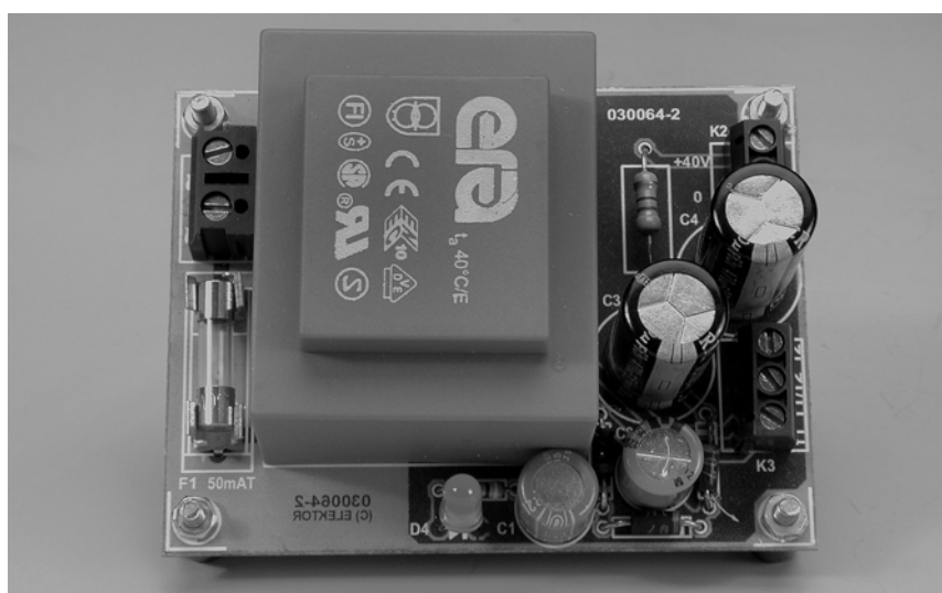
Figura 1. Una fuente de alimentación simple.
