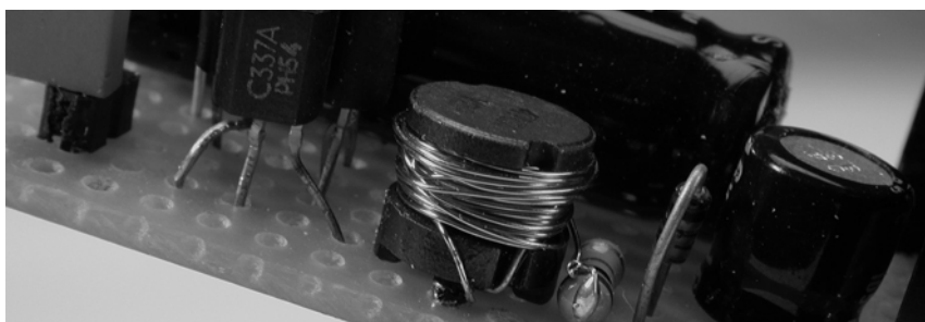
Figura 2. Detalle de la bobina L1.
