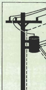
TRANSFORMADOR REDUCTOR DE DISTRIBUCIÓN (0,1-1μT, DISMINUCIÓN DEL CAMPO MAGNÉTICO A 1/r^2 )
