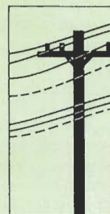
LÍNEAS DE DISTRIBUCIÓN PRIMARIA (4-35KV) 1-5μT, DISMINUCIÓN DEL CAMPO MAGNÉTICO A 1/r^2
