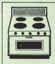
COCINA ELÉCTRICA 6-200μT, LA FUENTE PRINCIPAL DE CAMPOS MAGNÉTICOS ES LA RESISTENCIA CALEFACTORA. LA DISMINUCIÓN DEL CAMPO ES DE 1/r^2
