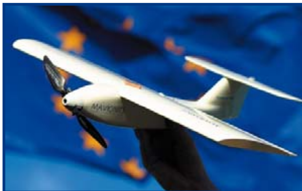
Figura 2. El "Carolo" es un ejemplo típico de un micro UAV que utiliza componentes de aeromodelismo para el avión.
