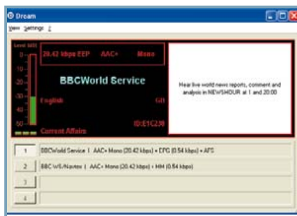
Figura 9. Una señal DRM desde el mezclador I-Q.
