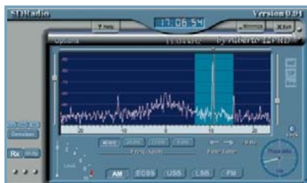
Figura 8. Frecuencia imagen suprimida con dos mezcladores.
