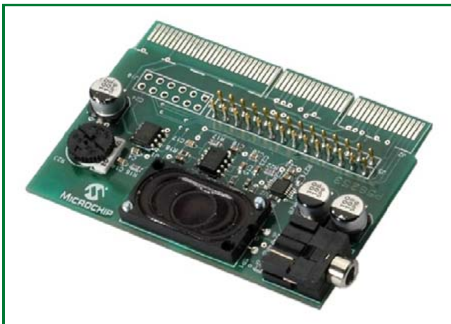
Figura 3. Placa PICtail Audio Plus contenida en el Paquete de Evaluación Explorer – 16.
