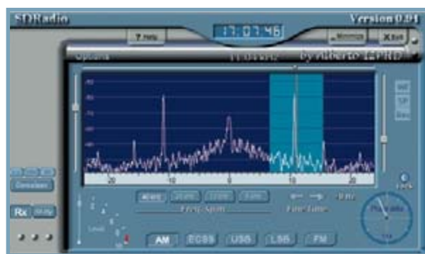
Figura 7. Frecuencia imagen con un sólo mezclador.
