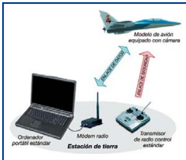
Figura 1. La estación de tierra "UAV de código fuente abierto" está formada por un ordenador portátil con un módem radio para las comunicaciones y un transmisor R/C (Radio Control) para apoyo al piloto automático.
