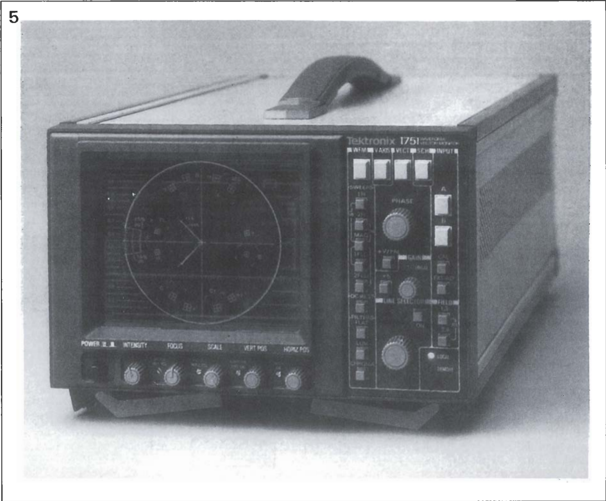
Figura 5. Vestorscopio. Este instrumento visualiza en su pantalla los vectores de los colores primarios y de la subportadora, representando su fase y amplitud.
