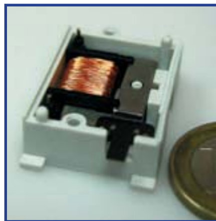
Figura 9. Un conmutador de luz, fabricado por EnOcean. Este conmutador sin hilos convierte la energía utilizada al presionar el conmutador en energía eléctrica, la cual alimenta un transmisor que activa un relé remoto.
