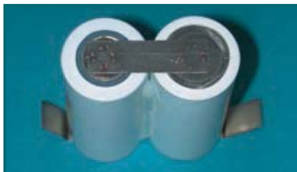
Figura 2. Ocho puntos de soldadura garantizan una baja resistencia de contacto.
