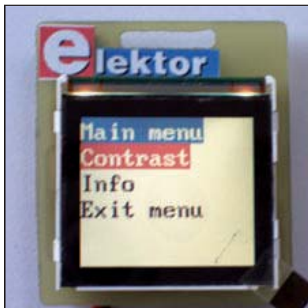
Figura 8. El microprocesador AVR controla incluso el ajuste del contraste.
