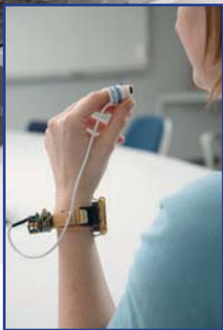
Figura 1. El prototipo del medidor de oxígeno en la sangre es ya lo suficientemente pequeño como para poder llevarlo como un reloj de pulsera.
