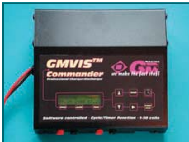
Figura 7. Este cargador, fabricado por la casa Graupner, permite una carga de corriente constante/tensión constante con un límite de 9,2 A y una tensión máxima de carga de 3,6 V por célula.
