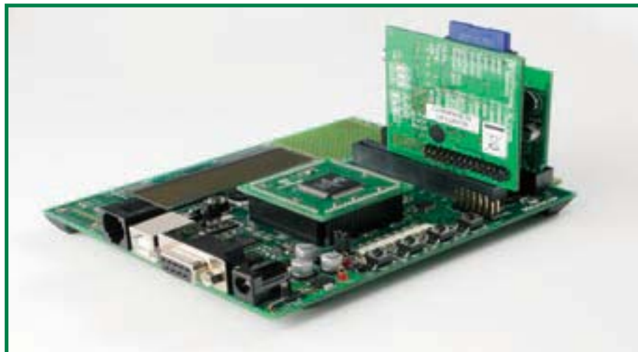
Figura 3. Tarjeta Audio Plus y tarjeta CF/MMC conectadas sobre el bus PICTail de la tarjeta de desarrollo Explorer-16.
