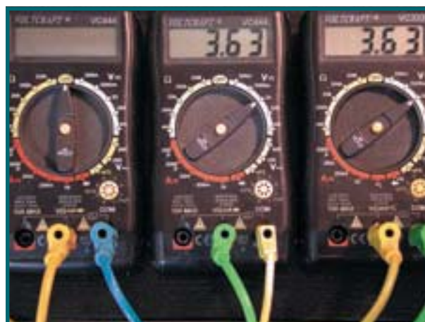
Figura 9. Una pequeña sobrecarga no afecta a la adaptación entre las dos células de la batería.
