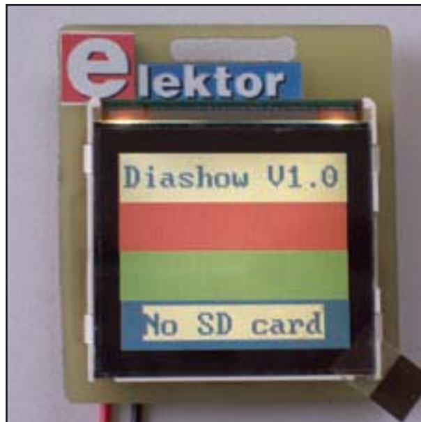
Figura 7. El micro AVR genera una imagen de prueba cuando el circuito se enciende por primera vez.the first time.
