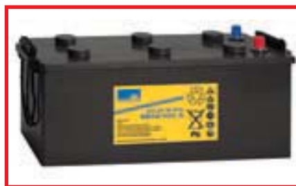
Figura 3. Las "Baterías solares", a diferencia de las baterías convencionales de ácido de plomo, están libres totalmente de mantenimiento y son menos propensas a la auto-descarga (foto: Deutsche Exide GmbH).
