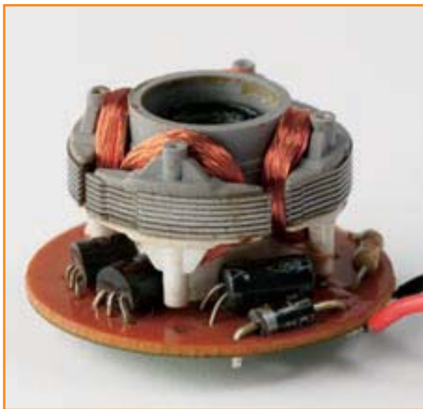
Figura 3. Como comparación hemos abierto un ventilador más viejo. La electrónica de control y el sensor lo constituyen componentes discretos.
