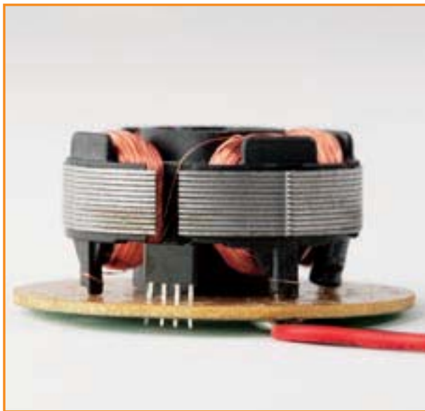
Figura 2. La denominación de generador de campo magnético rotativo es una controversia: toda la electrónica y el sensor Hall están en un circuito integrado de cuatro terminales. Aparte del condensador electrolítico no se requiere ningún otro componente.
