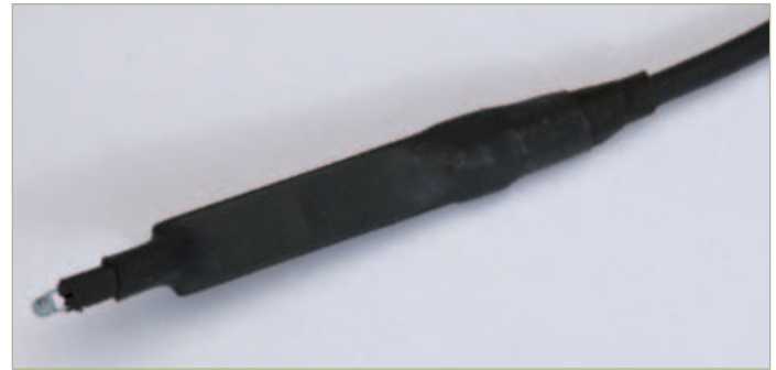
Figura 1. La placa del sensor, dentro de la prueba, forma una sonda de prueba de temperatura con una salida digital I2C.
