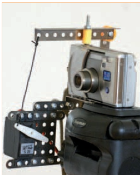
Figura 1. Prototipo, construido con algunos componentes de Mecano.
