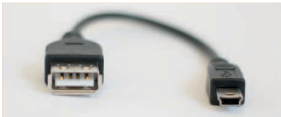
Figura 1. Conector USB micro-B a bus USB cable-A para utilizar una tableta en modo maestro.
