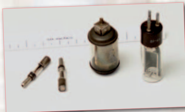
Los fototubos "Miniatura" fueron una de las innovaciones que hicieron posibles las películas con sonido en los años 30. Las pistas de sonido ópticas grababan la información de audio en el borde de la película. Los sistemas de sonido posteriores usaban tiras magnéticas, lo que se tradujo en una mejora de la calidad de sonido.
