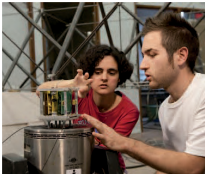
Prueba de vibración del cubesat sobre un vibrador (fuente: Cnes)
