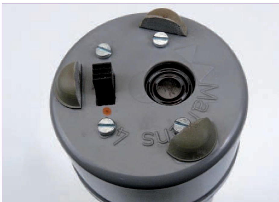
Figura 4. En la tapa se han montado un interruptor de conexión/desconexión y un altavoz.
