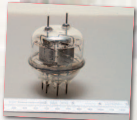
El tubo de transmisión 832-A de doble tetrodo. Un viejo favorito entre los aficionados a la radio a diferencia del modelo europeo QQE06/40, no estaba neutralizado (ver también el número de Retrónica de diciembre de 2008).
