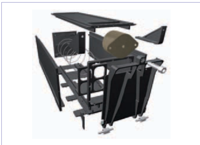
Figura 3. Modelo interconectado 3D de un "p-pod". (fuente: CubeSat Project)
