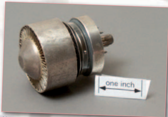
Un tetrodo 4X150 de un tubo transmisor de potencia. El ánodo de metal tiene aletas integradas para el enfriamiento con aire forzado. Fue my famoso: «todo radioaficionado tenía uno».
