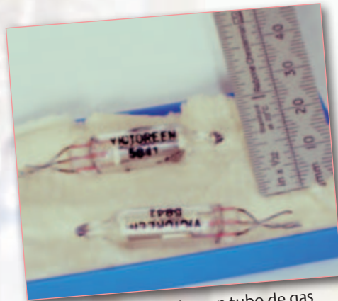
El Victoreen 5841 es un tubo de gas regulador de alta tensión, sub-miniatura. Regula a una tensión de 900 VDC para una carga comprendida entre 5-100 \mu A.
