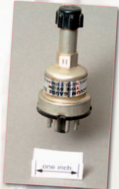
Dentro de este tubo hay un calentador y un termopar que genera una débil tensión dependiente del vacío. Una NPT de 1/8" montada sobre el mismo, conecta con el sistema de vacío.
