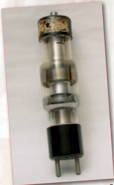
Este tubo de rayos X de los años 50 tiene una longitud aproximada de unos 33 cm. Dispone de un ánodo fijado y un cátodo. Los tubos modernos incrementan la potencia usando un ánodo largo que gira a alta velocidad.
