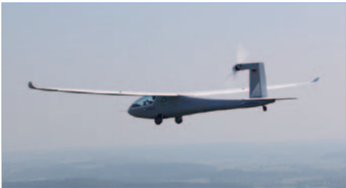
Figura 8. El anteriormente conocido como “Hydrogenius”, actualmente e-Genius, que utiliza una pila de combustible, se trata del avión eléctrico de la Universidad de Stuttgart presentado en el GFC. (Imagen: e-Genius-Team, IFB Universität Stuttgart)
