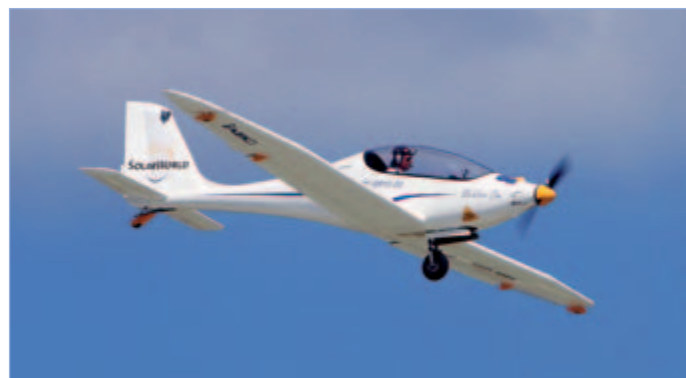
Figura 4. El Elektra One de la compañía alemana PC-Aero participa en el Green Flight Challenge (GFC) y se oferta con el hangar solar incluido, de Solarworld, para cargar las baterías. (Imagen: PC-Aero, Copyright Shahn Sederberg)
