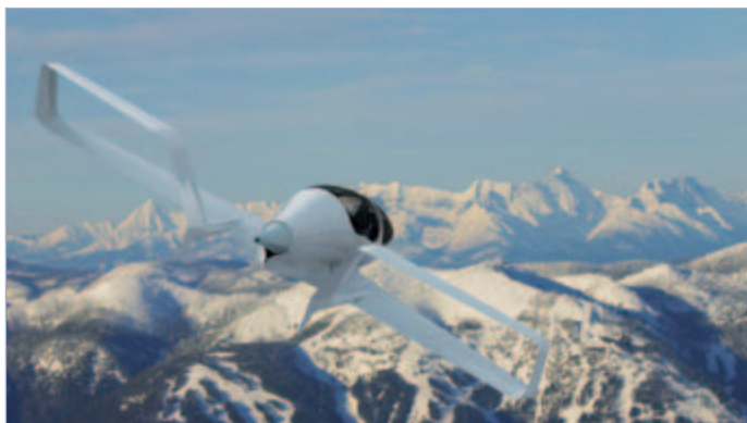
Figura 5. El Synergy, de seis plazas, participa en el GFC con un potente motor biodiesel de 142 kW (193 PS). (Imagen: CAFE Foundation Blog)
