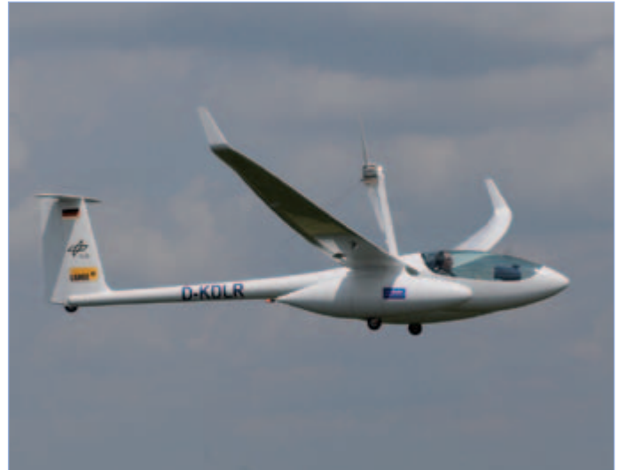
Figura 2. El Antares 20E de Lange Aviation – aquí en su versión DLR con tanque de hidrógeno y pila de combustible; se trata del primer avión considerado eléctrico EASA debido a su motor. (Imagen: DLR)
