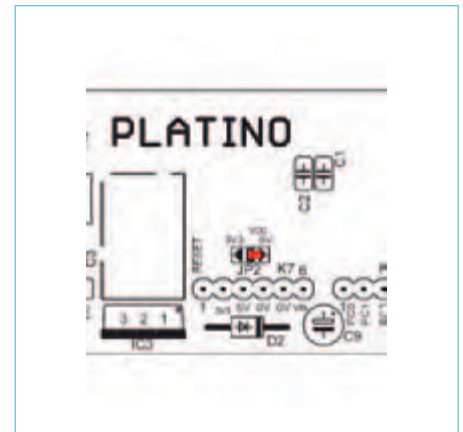
Figura 5. Cara "BOTTOM": un solo puente de soldadura.
