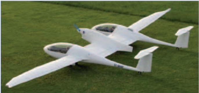
Figura 7. Pipistrel de Eslovenia ha combinado dos motores de planeador Taurus con un motor eléctrico de 145 kW para lograr un avión de doble propulsión en el GFC. En el concurso, esto tiene sentido a la hora de evaluar el consumo por pasajero. (Imagen: Pipistrel)
