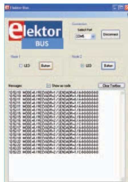
Figura 5. Captura del software para PC. Nuestra pequeña central puede activar los LEDs de los nodos y notificar los mensajes que circulan por el bus.
