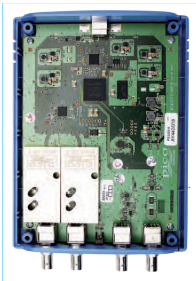
Figura 1. El interior de la nueva serie 3000 de Pico. Observa las secciones de entrada protegidas.
