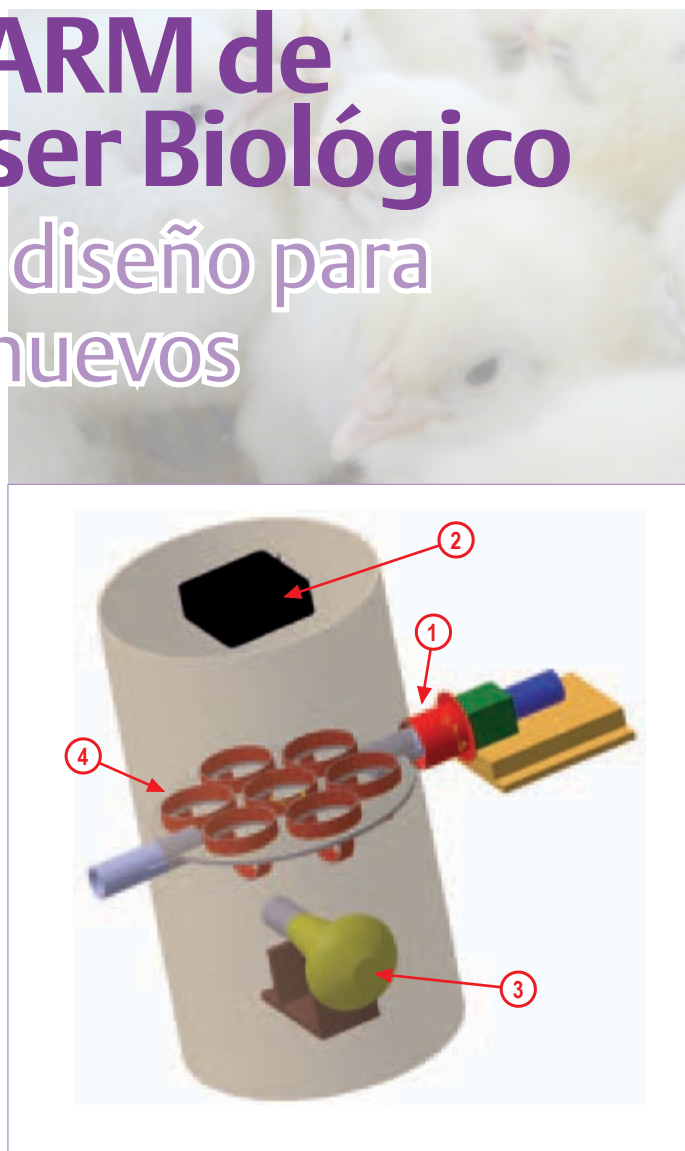
Figura 1. Impresión del artista de la cámara de incubación para huevos. 1: control de las marchas y eje del motor. 2: ventilador de PC. 3: bombilla de 25 vatios. 4: bandeja para los huevos.
