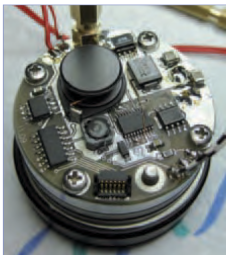
Figura 3. Tarjeta redonda montada con SMDs.
