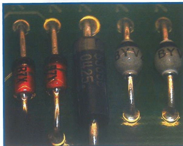
Figura 4. Debido a la falta de plomo, la forma de la unión es diferente.
