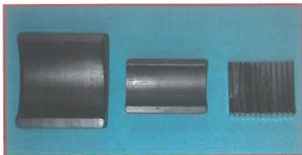
Figura 3. Los grandes imanes de ferrita han sido sustituidos por pequeños imanes basados en el material neodimio.
