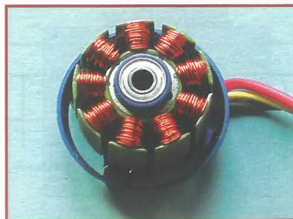
Figura 2. Un alto factor de relleno es importante, en este ejemplo aún queda espacio para realizar mejoras!
