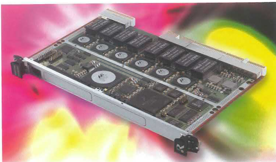
El CPX24 ruggedizado es compatible con PICMG2.16 y soporta IPv6.
