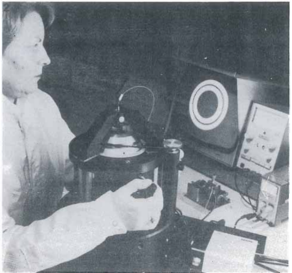
Fotografía 2. Por medio de un sistema de control óptico puede controlarse a simple vista el centrado preciso de la fibra respecto al eje del torno. Para ello basta con observar que los dos anillos visualizados en la pantalla sean exactamente concéntricos.
