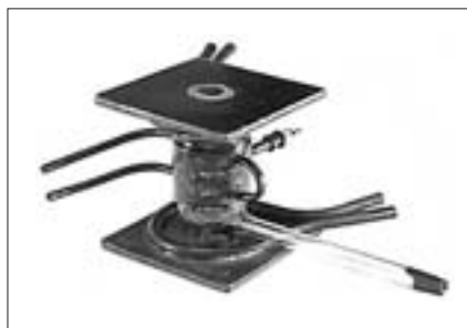
Prototipo de magnetron de cavidad, construido por Boot y Randall en 1940. La unidad entregaba 400 W a 3 GHz e iba refrigerada por agua. (Foto cortesía del War Museum)
