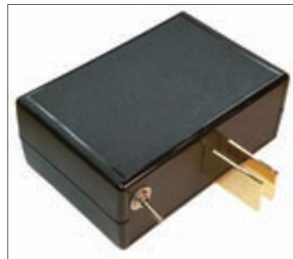
Foto H. El manipulador P1PAD de CW TouchKeyer es totalmente electrónico, no tiene ninguna parte mecánica. Emplea transistores FET en conmutación para una operación totalmente "silenciosa", y un tono auxiliar para monitorización.
