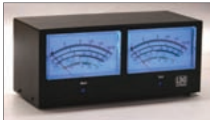
Foto F. Medidor DM-7800 de LDG Electronics, creado para el transceptor ICOM IC-7800. Son dos visores de 11,4 cm de largo, uno para el receptor principal y otro para el secundario (ver texto).
