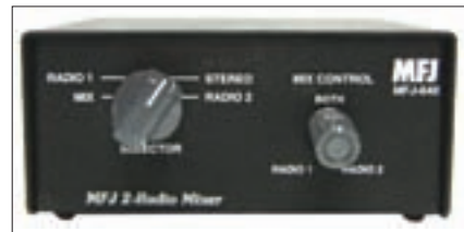
Foto D. El MFJ-640 combina o mezcla dos señales de audio procedentes de dos receptores diferentes. Se afirma que es de gran utilidad para operar en "split" en concursos de HF y DX, así como con satélites de VHF/UHF en banda cruzada.
