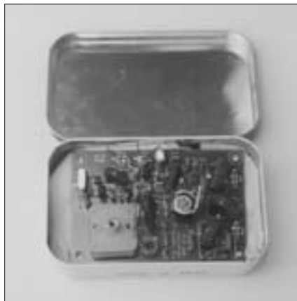
Foto C. El Twofer totalmente montado, probado y listo para operar, instalado en una lata de pastillas de menta Altoids. Tras añadir mi modificación, descrita en el texto, lo cambié a una caja de plástico de forma que radiase libremente una señal de BFO por conversión directa al receptor de onda corta en AM al lado.
