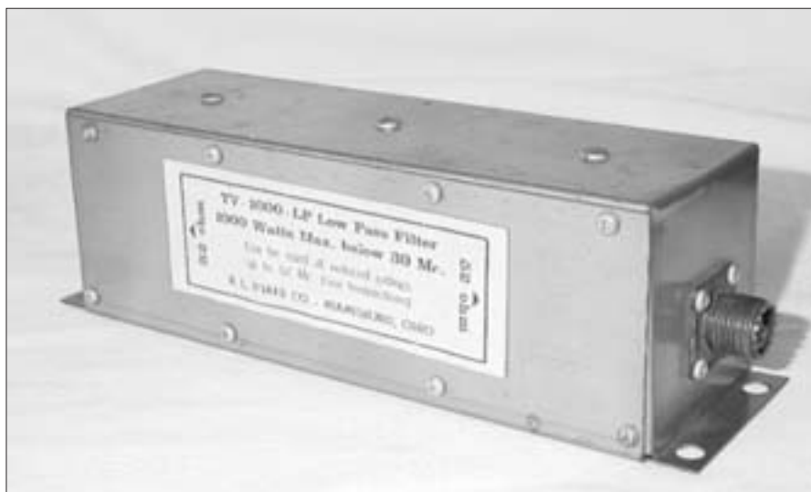
Foto A. Un filtro pasa bajos como el TV 1000 de Drake, conectado entre el transmisor y la antena, reduce sustancialmente el nivel de las señales espurias por encima de 54 MHz generadas por el transmisor.
