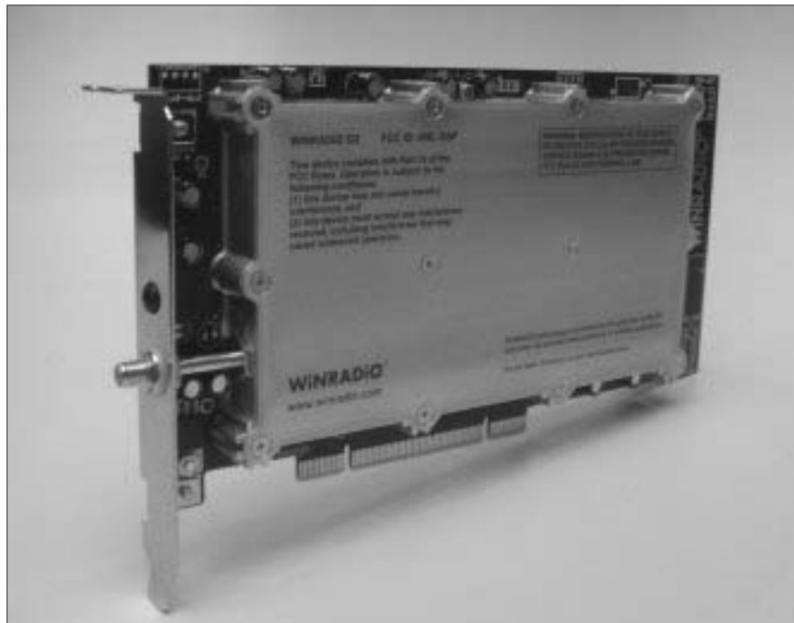
Foto A. Receptor SDR WinRADIO WR-G305i. Cubre el margen de 9 kHz a 1800 MHz, expandible hasta 3500 MHz. Se inserta en una ranura PCI convencional de cualquier ordenador de sobremesa moderno. Todas las fotos cortesía de los fabricantes.
