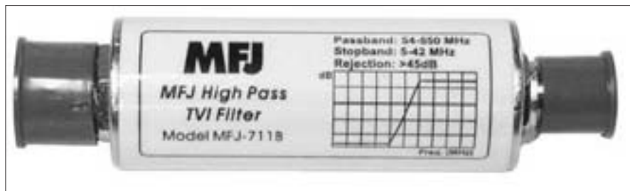
Foto B. El filtro pasa altos MFJ-711B es uno de los más eficaces del mercado para reducir la interferencia en televisores causada por sobrecarga de la señal fundamental, pues no sólo filtra el conductor central sino también la malla..
