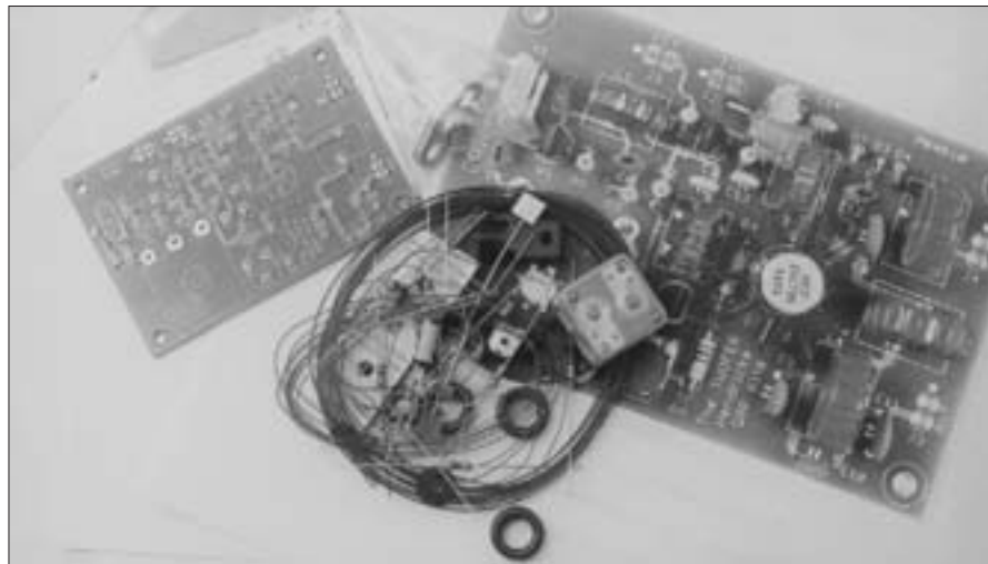
Foto A. El transmisor en kit Twofer tal y como fue recibido de K16DS ( www.qrpkits.com ), y a la derecha una foto ampliada del kit montado obtenida del sitio web. El transmisor entrega 2 vatios de salida, incluye control de frecuencia por VXO, y puede ser construido para 40, 30 ó 20 metros. Es un buen kit, asequible, y de primera clase.
