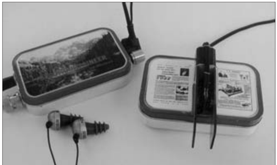
Foto D. De acuerdo con la filosofía de que "si cabe en una lata de Altoids es un verdadero equipo QRP", Dennis, N9JXY, construyó esta estación. El equipo a la izquierda es un minitransceptor Micromountaineer diseñado por W7ZOI. El aparato a la derecha es un Jacks-on Harbor en una lata con un manipulador de construcción propia fijado a la tapa. Foto cortesía de N9JXY.
