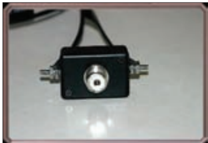
Foto I. El nuevo y versátil conector de K4AVU puede ser empleado para izar una antena dipolo en V invertida, o para conectar una línea paralela y un cable coaxial. En la foto no se aprecia el cáncamo en la parte superior.
