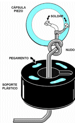
Figura 6 Para montar el disco piezoelectrico en el soporte de plástico cilíndrico hay que soldar el hilo central del cable apantallado en el centro del disco y la malla metálica en el borde exterior. Una vez realizada la soldadura hay que fijar el disco al soporte utilizando pegamento.
