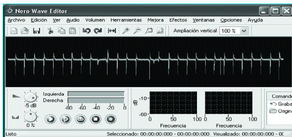
Figura 1 - Con el estetoscopio LX1655 se pueden visualizar en la PC las pulsaciones cardíacas. Quien disponga de un editor de audio puede registrar, editar y escuchar las señales captadas.
