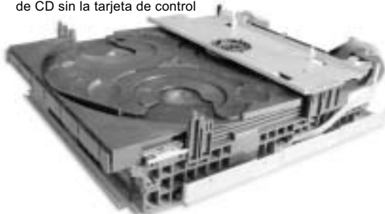
Sistema mecánico del reproductor de CD sin la tarjeta de control
