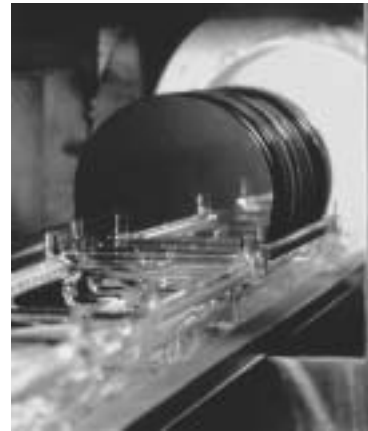
Obleas de silicio cortadas de una barra y listas para su dopado.
