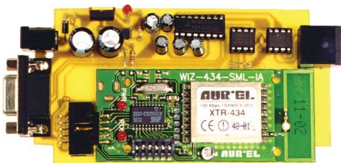
Il PC è collegato al modulo di conversione RS232/485 dal quale parte il cavo di collegamento per l'unità remota. Per evitare l'impiego dei fili, è necessario integrare questo circuito con un modulo radio WIZ-434, come si vede nella foto.
