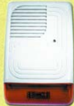
Sirena elettronica da esterno IP 34. Contenitore in policarbonato autoestinguente; blindatura interna in acciaio zincato; lampeggiatore ad alta resa; Tamper; resa acustica di 128 dB ad un metro; assorbimento medio in allarme di 2,5 A; assorbimento a riposo di 5 mA; peso 3000 g.; vano per batteria da 7 Ah 12V (non compresa); dimensioni 295 x 200 x 100 mm. Cod. SI/128 L. 155.000
