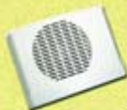
Sirena piezoelettrica da interno. Contenitore in ABS bianco; Tamper; resa acustica di 115 dB ad un metro; angolo di dispersione di 90°; assorbimento in allarme di 400 mA; alimentazione 9 + 13 Vcc; peso 230 g.; dimensioni 100 x 138 x 39 mm. Cod. SI/BETTY L. 48.000
