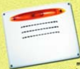
Sirena elettronica da esterno IP34. Contenitore in policarbonato autoestinguente; blindatura interna in acciaio zincato; lampeggiatore ad alta resa; Tamper; resa acustica di 120dB ad un metro; assorbimento medio in allarme di 1,5 A; assorbimento a riposo di 18 mA; peso 1650 g.; vano per batteria da 2,6 Ah 12V (non compresa); dimensioni 260 x 205 x 95 mm. Cod. SI/120 L. 124.000
