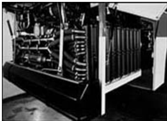
Un motore prodotto nel 1995 funzionante tramite le celle a combustibile montato su un autobus. Sviluppa una potenza equivalente a 205 Kw e garantisce un'autonomia pari a 400 Km.
