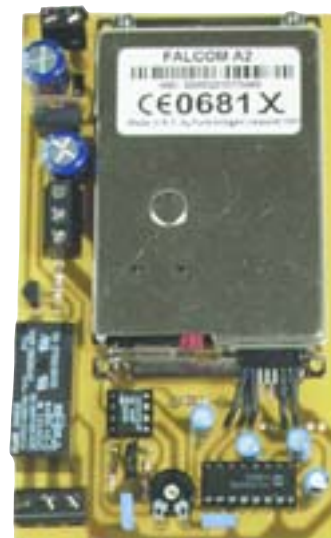
Circuito stampato, in dimensioni reali, dell'attivatore remoto GSM e prototipo dello stesso a montaggio ultimato. Il dispositivo utilizza un modulo cellulare Falcom A2.
