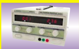
Alimentatore 0-30Vdc/0-20A
