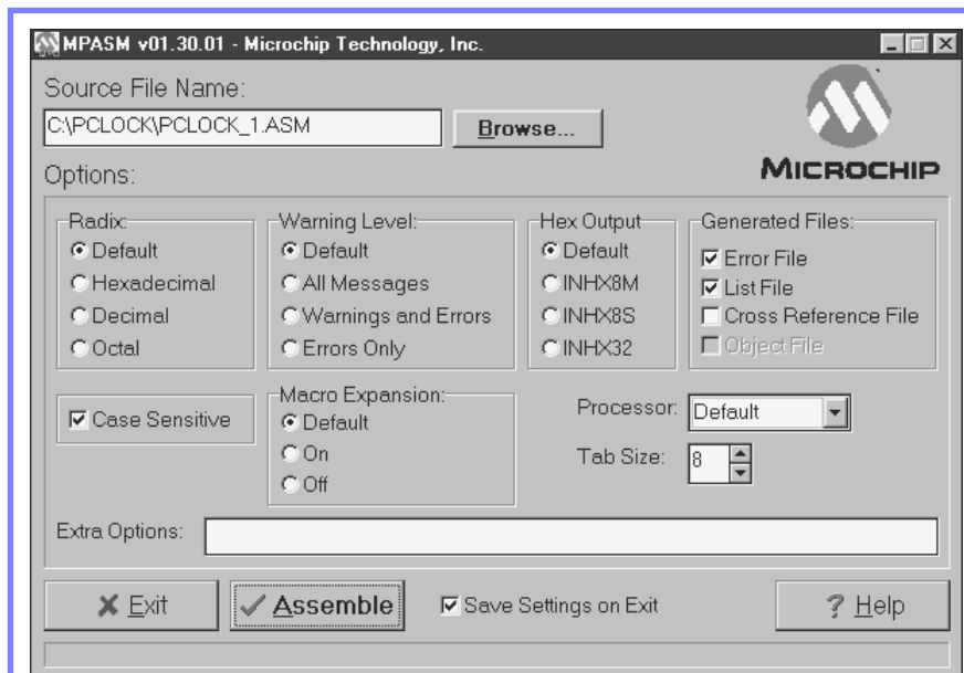
La schermata del programma MPASM della Microchip indispensabile per compilare il programma assembler in file sorgente, da trasferire nei PIC.
