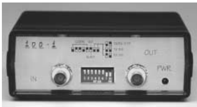
Ecco come appare il video scrambler montato e racchiuso nella scatola in plastica completa di frontalini serigrafati.
