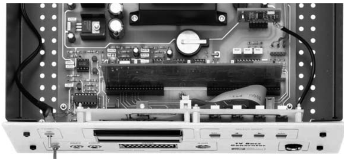
Fig.19 En esta fotografía se puede observar el circuito impreso SMD KM.1631 instalado en el conector CONN.5 del la tarjeta base LX.1630 y el circuito impreso LX.1630/B fijado en el panel frontal del mueble.
