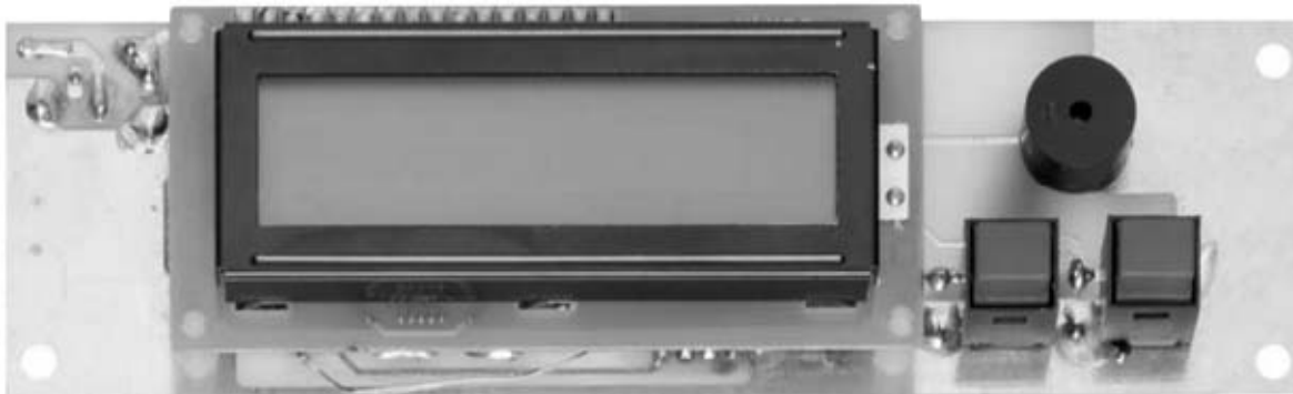
Fig.18 Así se presenta el circuito LX.1627/B una vez realizado el montaje de todos sus componentes. Además del display LCD el circuito contiene el pulsador SEL/CAL, el pulsador START/PAUSE y el zumbador que señala con un pitido la finalización de la aplicación.
