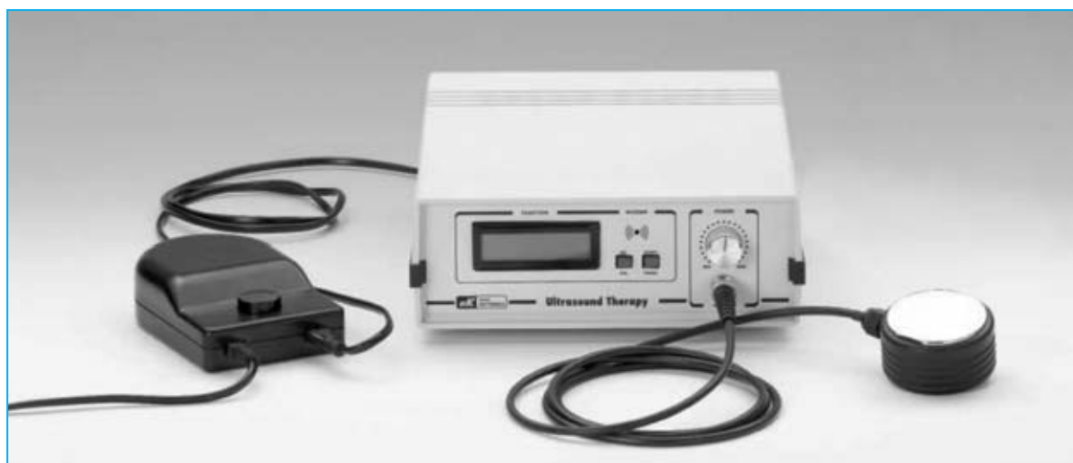
Fig.25 El Generador de Ultrasonidos equipado con el alimentador externo y con el difusor. El cable de conexión al difusor, de 1,6 m de longitud, permite alcanzar fácilmente cualquier parte del cuerpo.
