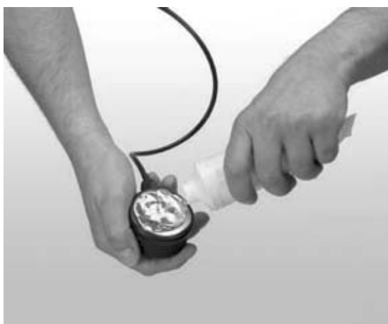
Fig.22 Antes de utilizar el difusor hay que aplicarle SIEMPRE una capa de gel conductor de 1 mm de espesor. No hay que olvidar realizar esta operación ya que os arriesgaríais a estropear el difusor y a provocaros quemaduras.
