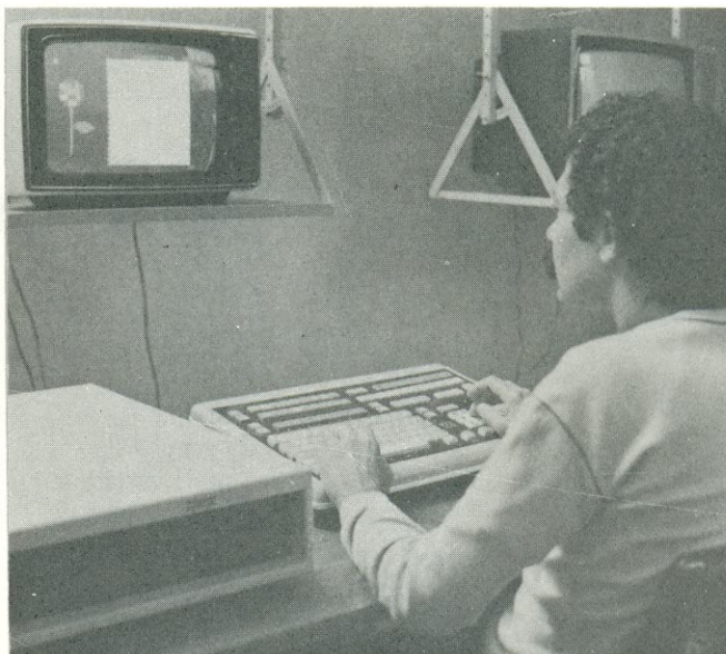
Editor/diagramador numa central de edição, onde se pode ver o teclado do terminal, a unidade de disquete e o monitor de TV.
