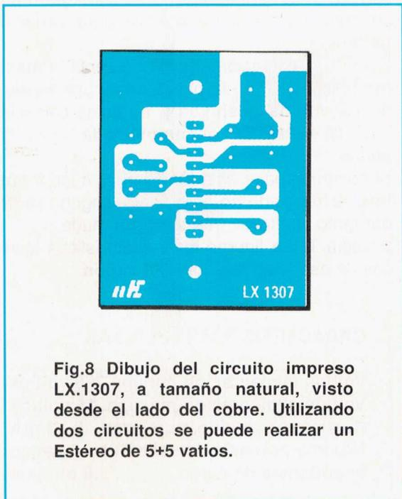
Fig.8 Dibujo del circuito impreso LX.1307, a tamaño natural, visto desde el lado del cobre. Utilizando dos circuitos se puede realizar un Estéreo de 5+5 vatios.
