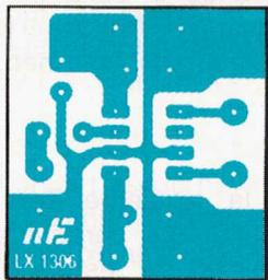
Fig.3 Dibujo del circuito impreso a tamaño natural visto desde el lado del cobre.
