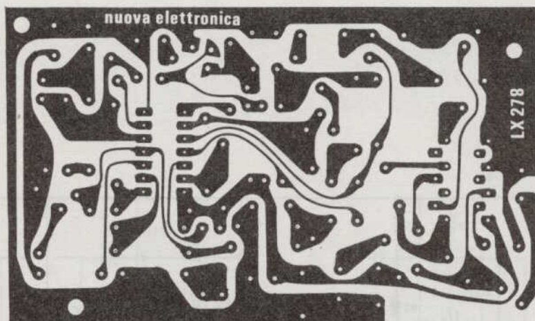
Figura 2 Dibujo del circuito impreso necesario para realizar este diseño, a tamaño natural.
