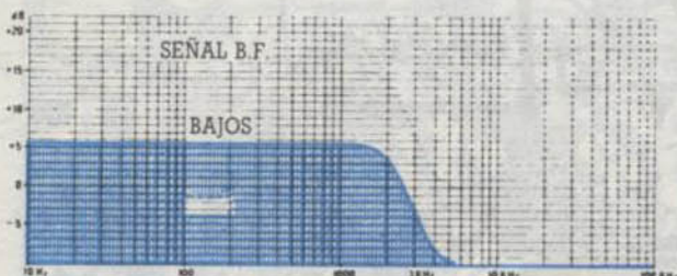
Figura 3 Evitando la amplificación de esta parte de la banda, cuando sólo hay señales de bajos y medios, automáticamente se elimina el ruido.
