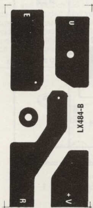
Figura 5 Circuito impreso en tamaño natural para fijar debajo de la aleta de refrigeración de forma que se puedan soldar los terminales del LM.338K.
