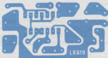
Figura 4 Dibujo a tamaño natural del circuito impreso necesario para realizar este diseño.
