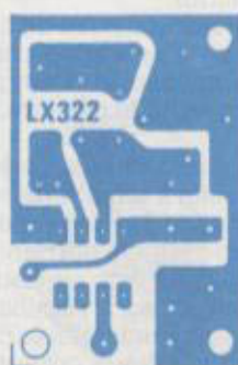
Figura 4 Circuito impreso a tamaño natural.
