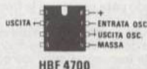
Figura 2 Conexiones de los terminales del integrado HBF.4700 visto desde arriba.
