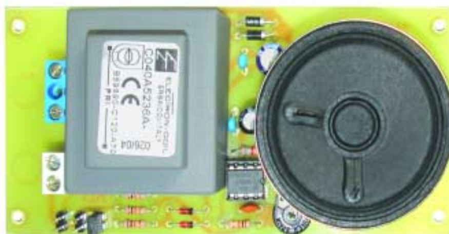
Il trasformatore deve essere scelto del tipo per circuito stampato, con i terminali disposti come previsto dalle piazzole del circuito stampato. L'altoparlante va incollato con il magnete alla basetta.
