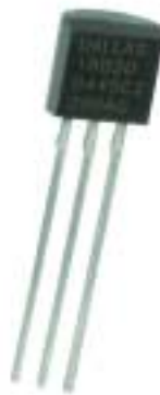
Il sensore di temperatura DS18B20 misura da -55 a +125°C.
