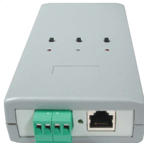
Conviene racchiudere l'unità di controllo in un contenitore plastico dal quale spuntino le morsettiere, l'RJ45 per la connessione con il modem o router ADSL, e i quattro led.
