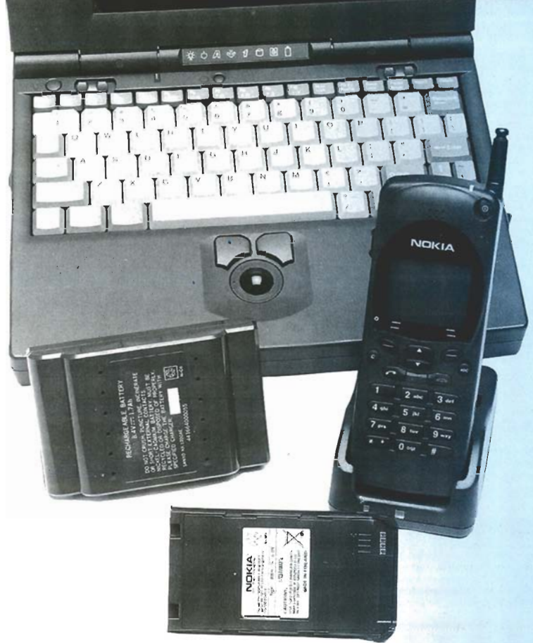
Figura 3. Las baterías son producidas en gran cantidad de formas y tamaños. En la figura se muestran dos modernas versiones de baterías de NiMH.
