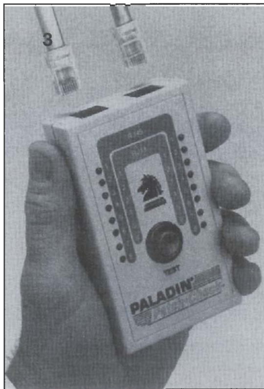
Figura 3. - El Patch Check de Paladin proporciona una información instantánea de funcionamiento o no funcionamiento de los conectores RJ-11 y RJ-45 de tipo telefónico utilizados con los cables de par trenzado apantallados y no apantallados.
