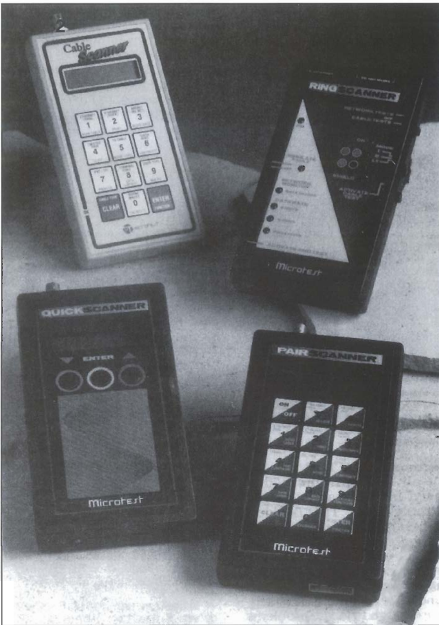
Figura 2. - Los comprobadores de redes locales de mano de Microtest combinan las prestaciones más necesarias con la facilidad de uso y un formato manual. En el sentido de las agujas del reloj desde la esquina superior izquierda se muestran el Cable Scanner, el Ring Scanner, el Pair Scanner y el Quick Scanner.
