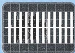
Forma de onda en el punto de prueba-e. Es la forma de onda de la señal de la antena. La amplitud de la señal modulada es aproximadamente igual a 8V.
