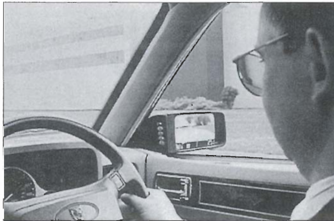
5.- Sistema anticolidión de corto alcance desarrollado por la firma JAGUAR. Sensores infrarrojos de altas características y bajo precio son situados en las partes trasera y frontal del automóvil con objeto de poder detectar los obstáculos existentes en la calzada, independientemente de la dirección que lleve el vehículo.
