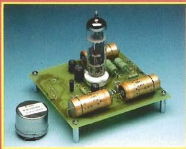
Preamplificador RIAA a válvulas
