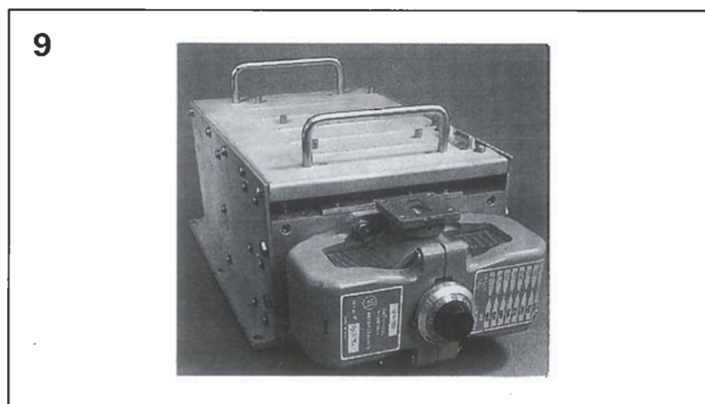
Figura 9. Magnetron convencional VARIAN SFD-352. La salida es por guíaonda y está situada en la zona superior de su parte frontal. Puede sintonizarse desde 8,5 a 9,6 GHz. La potencia de pico es de 220 kilovatios, la tensión nominal de ánodo es de 22 kilovatios, y la corriente de pico de ánodo es de 28 amperios.
