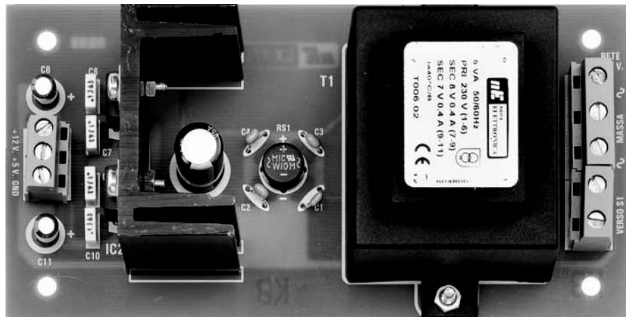
Fig.11 el alimentador LX.1701, creado para el Generador DDS, suministra las dos alimentaciones adaptas a la tarjeta USB, por medio de dos estabilizadores. Montados en una aleta pueden suministrar hasta 1 Amperio de corriente: siendo más de lo que se necesita en la mayoría de las aplicaciones.
