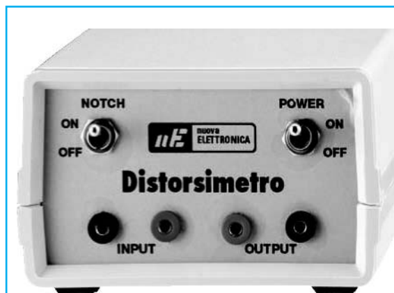
Fig.6 fotografía del frontal de aluminio del mueble mecanizado y serigrafiado.
